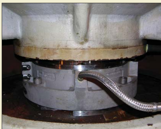
O conserto e a instalação do selo bipartido ocorrem sem desmontar o equipamento, economizando tempo e custos operacionais.
